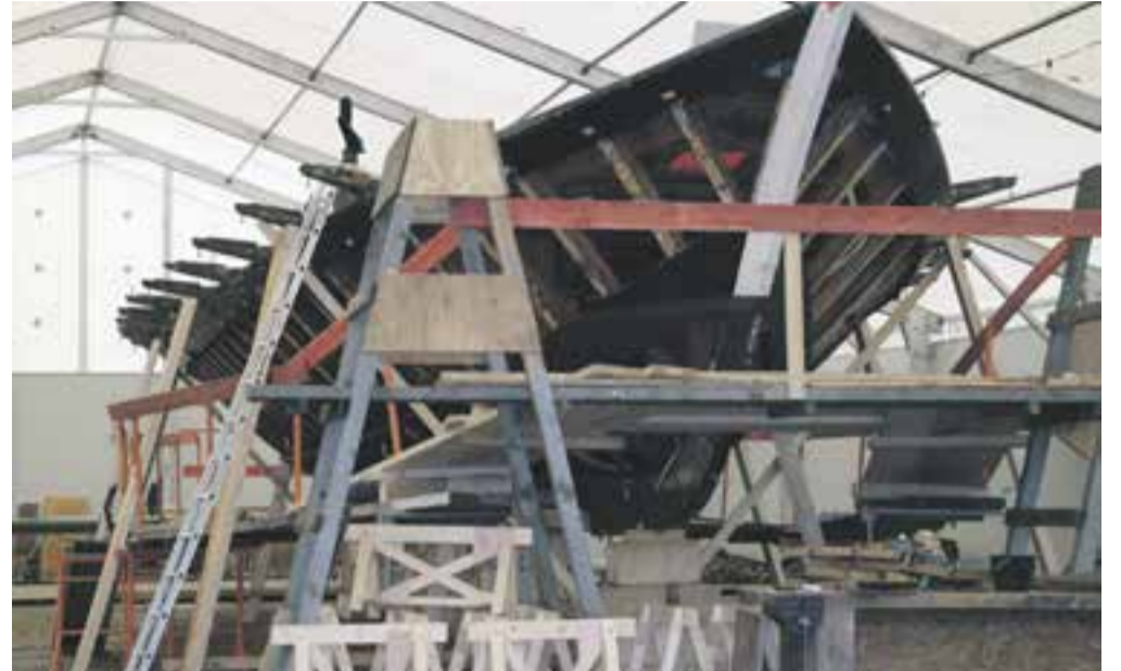
Une importante rénovation de la quille jusqu'aux mâts en passant par la coque et le pont.
